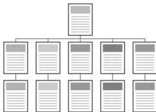
ภาพที่ 2. 11 แสดงโครงสร้างเว็บไซต์แบบลำดับชั้น
