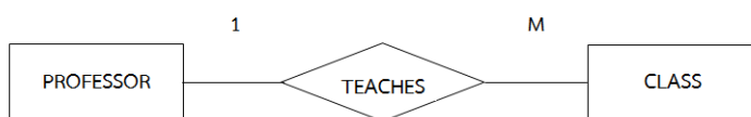
ภาพที่ 2.8 แสดงความสัมพันธ์แบบ One to Many Relationships
