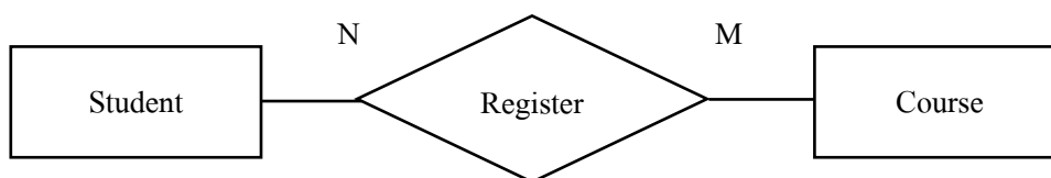
ภาพที่ 2.3 แสดงความสัมพันธ์แบบ Many to Many Relationships
