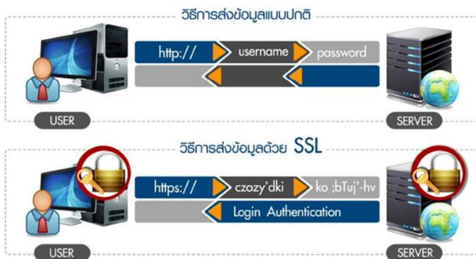
ภาพที่ 2.2 ตัวอย่างของการส่งข้อมูลด้วย SSL
