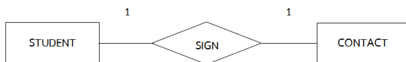
ภาพที่ 2.2 แสดงความสัมพันธ์แบบ One To One
