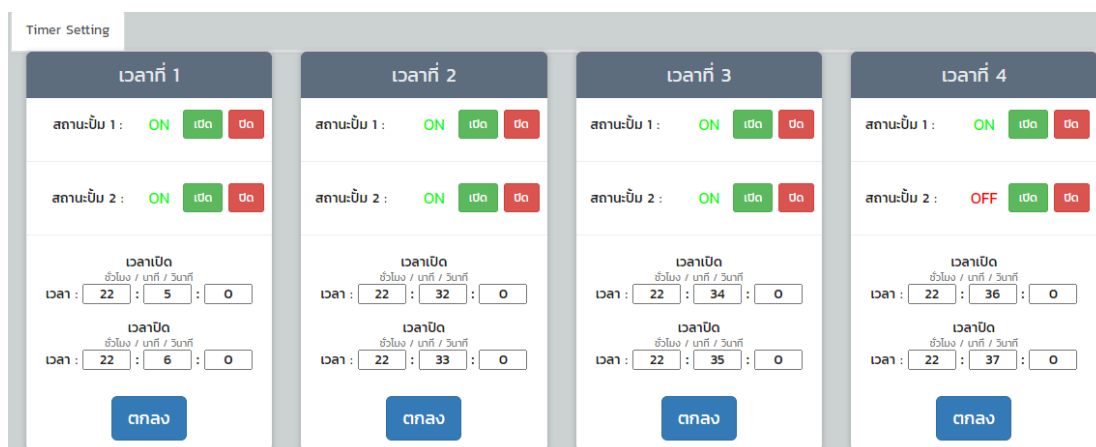
ภาพที่ 4.7 ส่วนแสดงผลและตั้งค่าเวลาในการทำงานของปั๊มน้ำ
