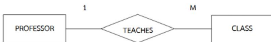
ภาพที่ 2.4 แสดงความสัมพันธ์แบบ One to Many Relationships
