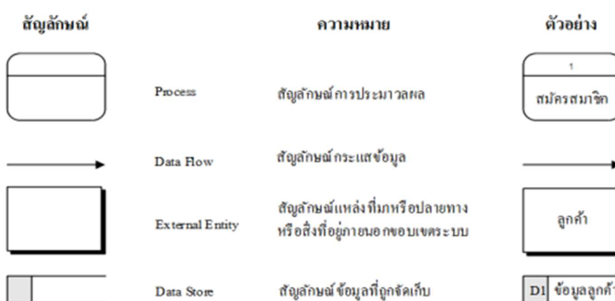
ภาพที่ 2.1 แผนภาพกระแสข้อมูล (Data Flow Diagram: DFD)
