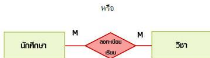
ภาพที่ 2.7 แสดงความสัมพันธ์แบบ Many to Many Relationships
