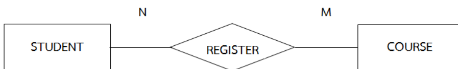
ภาพที่ 2.5 แสดงความสัมพันธ์แบบ Many to Many Relationships
