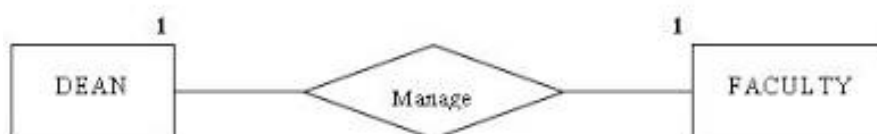
ภาพที่ 2.3 ความสัมพันธ์แบบ หนึ่ง-ต่อ-หนึ่ง (one-to-one)
