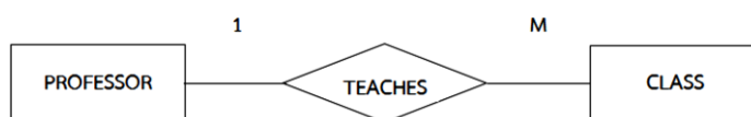
ภาพที่ 2.10 แสดงความสัมพันธ์แบบ One to Many Relationships
