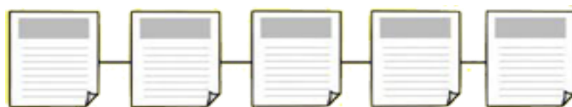
ภาพที่ 2.1 แสดงโครงสร้างของเว็บไซต์แบบเรียงตามลำดับ (Sequential Structure)
