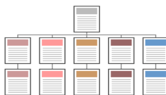
ภาพที่ 2.2 แสดงโครงสร้างของเว็บไซต์แบบลำดับขั้น (Hierarchical Structure)
