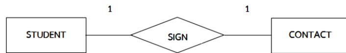
ภาพที่ 2.10 แบบหนึ่งต่อหนึ่ง (One to One Relationships)
