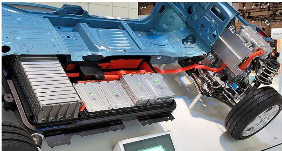
รูปภาพที่ 2.3 ระบบขับเคลื่อนของรถยนต์ไฟฟ้า "Nissan Leaf 012" ของ Tennen-Gas
