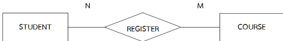
ภาพที่ 2.4 แสดงความสัมพันธ์แบบ Many to Many
