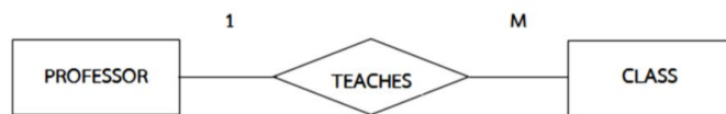
ภาพที่ 2.4 แสดงรูปแบบความสัมพันธ์แบบหนึ่งต่อกลุ่ม (One to Many Relationships)
